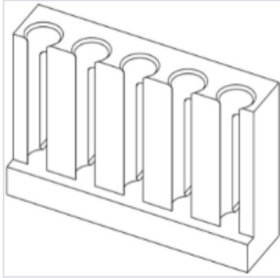
7. 本外观设计产品的名称：试剂架。 2. 本外观设计产品的用途：用于放试剂瓶。 3. 本外观设计产品的设计要点：在于形状。 4. 最能表明设计要点的图片或照片：立体图 1。
